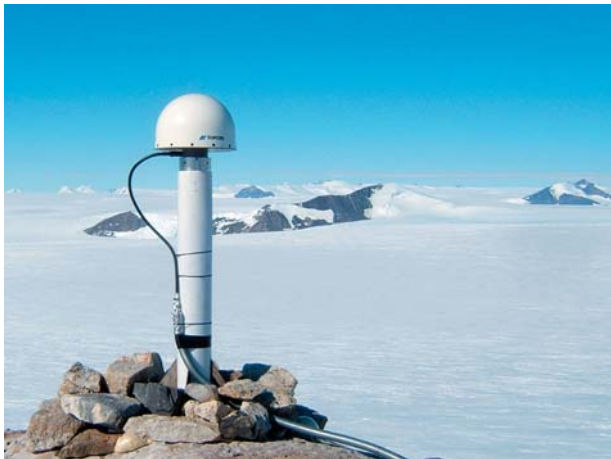
Abb. 1: GPS-Permanentstation im Gebiet der russischen Antarktisstation Leningradskaya in Oates-Land, Ostantarktis. (Foto: L. Eberlein)
